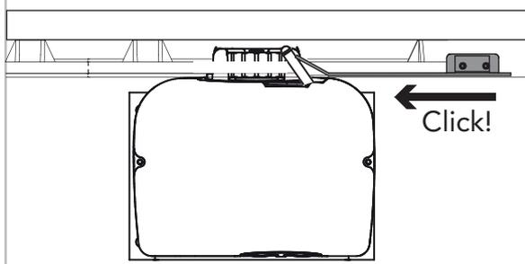
À la fin de l'installation déplacer manuellement le portail en ouverture et fermeture et vérifier que les pattes activent toujours l'interrupteur de fin de course avant que le portail atteigne les butées d'arrêt mécanique. Cette vérification assure le bon fonctionnement de la motorisation et préserve la structure mécanique du portail, comme du moteur.
