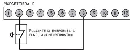
**N.B.:** Se provvisoriamente non è stato utilizzato il contatto di STOP ponticellare il morsetti 2 - 8.
